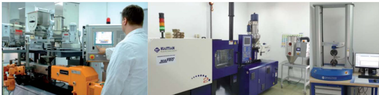
Aparatura do wytwarzania biokompozytów (wyłצarczarka i wtryskarka) i badania ich właściwości mechanicznych (maszyna wytrzymałościowa)
