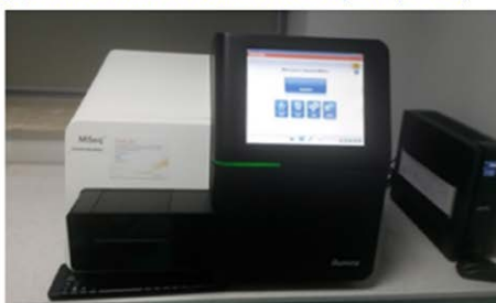
MiSeq wykorzystywany do sekwencjonowania nowej generacji NGS
